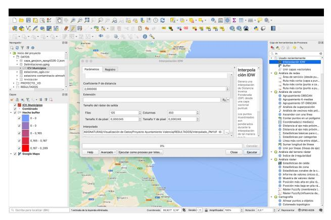
Sin embargo, obtenemos un ráster rectangular, ya que los puntos de muestreo se ponderan durante la interpolación de tal manera que la influencia de un punto en relación con otros disminuye con la distancia desde el punto desconocido que se desea crear. El ráster debemos cortarlo por capa de máscara para visualizar únicamente las zonas de Valencia que necesitamos
